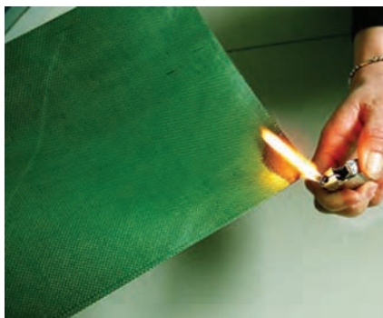
تصویر ۷- نانوپارچه ضد حریق
